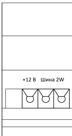
Рис. 3. Расположение клемм питания и шины 2W
