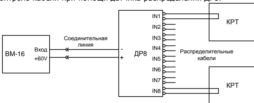
Рис. 15. Схема контроля кабеля при помощи датчика распределения ДР8
