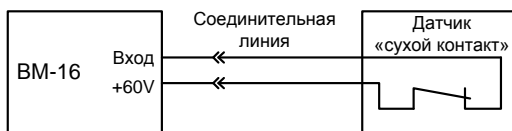
Рис. 6. Непосредственное подключение датчика типа «сухой контакт»
