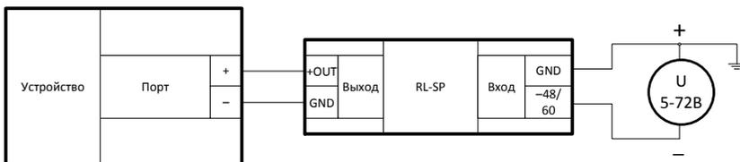
Рисунок 9 – Подключение модуля RL-SP для измерения напряжения
