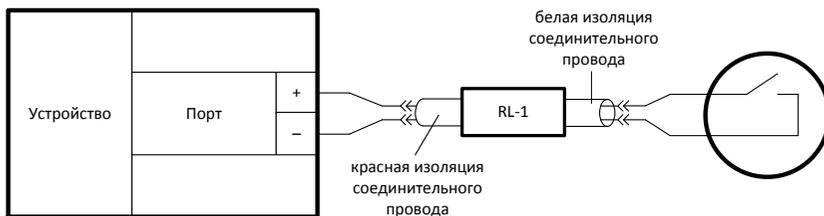
Рисунок 7 – Подключение датчика с помощью модуля RL-1
