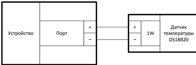
Рисунок 13 – Схема подключения датчика температуры
