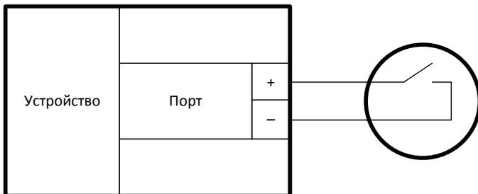
Рисунок 6 – Подключение датчика с выходом типа «Сухой контакт»
