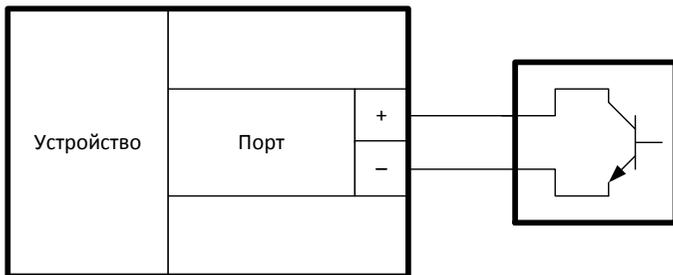
Рисунок 8 – Подключение датчика с выходом типа «Открытый коллектор»
