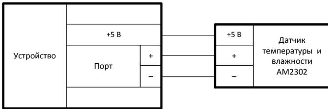
Рисунок 17 – Схема подключения датчика температуры и влажности
