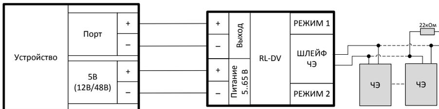
Рисунок 16 – Подключение шлейфа затопления через RL-DV
