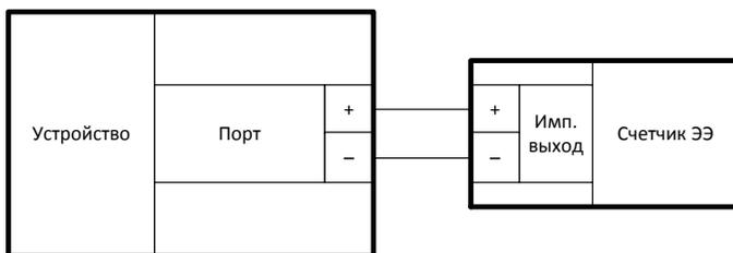
Рисунок 10 – Подключение импульсного выхода счетчика электроэнергии
