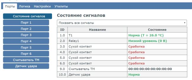
Когда температура внутри шкафа поднимется выше 30 °C реле перейдет во включенное состояние, до тех пор, пока температура не опустится ниже 27 °C.
