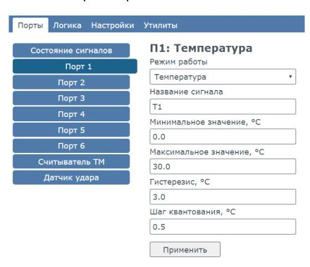
3. Настроим порт 2 в режим «Управляемый выход» и подключим к нему вход реле. Зададим автоматический режим управления и в качестве управляющего сигнала, выберем сигнал температуры Т1. Пока сигнал Т1 находится в состоянии «Выше нормы» выход должен сохранять высокий уровень (3.3 В).
