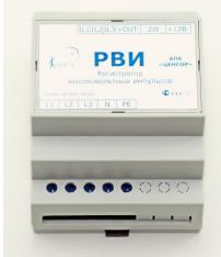
Импульсное перенапряжение часто возникает из-за попадания грозового разряда – распространённого явления, приводящего к выходу оборудования из строя. Кроме того, нередко высоковольтные импульсы вызваны коммутацией силовой аппаратуры, при которой возникает искра, дуга, паразитная наводка, вызывающая импульс перенапряжения на токоведущей цепи.
